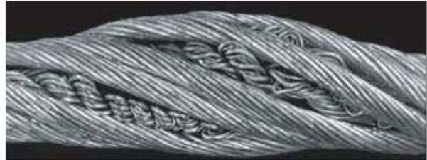
Esta falla se produce porque el alma de acero se ha movido en la parte interna, produciendo que junto con los cordones exteriores se recojan en un punto específico, frecuentemente antes de entrar a la polea.
