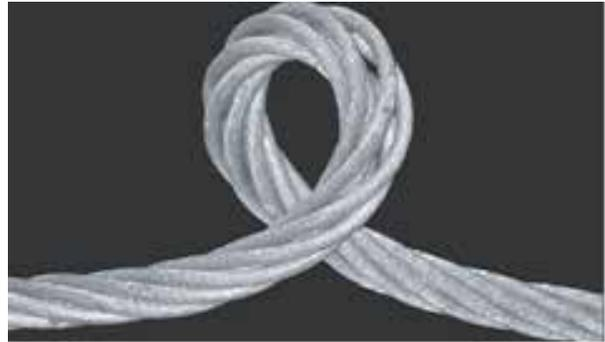
“COCA” formada en un cable en uso, se produce debido a que el cable fue instalado con “VIDA” o que fue mal desenrollado del carrete y la coca se forma al retirar la carga con la que trabajaba.
