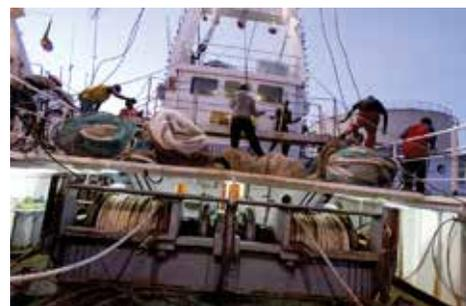
Son utilizados en la industria pesquera y naviera, en aquellas áreas donde la abrasión es el factor predominante. El alma de fibra le proporciona al cable una flexibilidad adicional que debe ser utilizada si las cargas de trabajo no producen aplastamiento.
