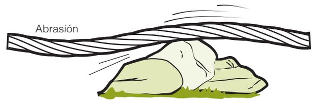
En los Cables de Acero la abrasión se produce con el roce y la fatiga por dobleces reiterados.
